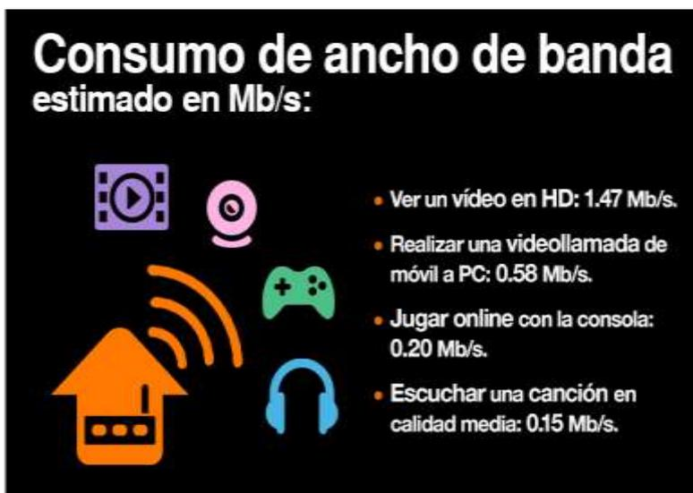
Figura 10. Consumo de ancho de banda estimado
