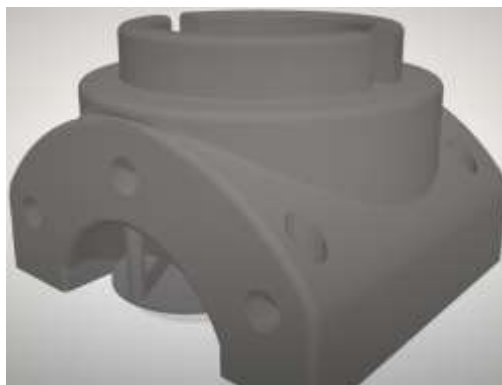
Figura 24. Modelo 3D de la base del motor.
