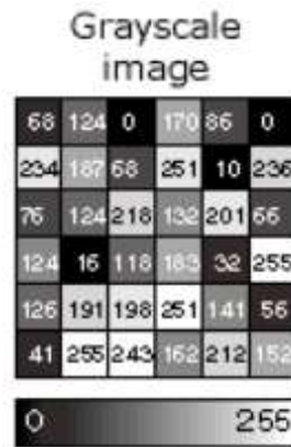
Figura 10. Estructura de una imagen en escala de grises.
