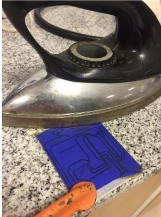
*Figura 32.* Planchado de Papel Transfer sobre Baquelita.
