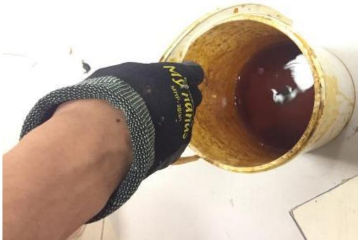
*Figura 34.* Baño de Ácido Férrico a las placas.
