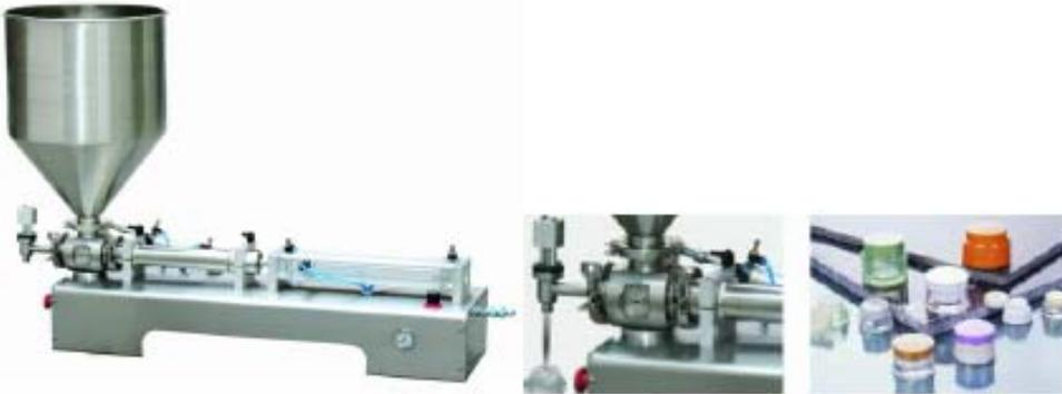
Llenadora de líquidos viscosos semi automática, de estructura en acero inoxidable 304 y partes en contacto con líquidos son de acero 316, sus componentes neumáticos son marca Festo (Alemania). Tanto el volumen y velocidad de llenado pueden ser ajustadas y su precisión de llenado es alta. Boquillas dosificadoras ante derrame. Su accionamiento es con pedal e incluye una tolva de alimentación de 35 litros. Requiere compresor de aire (no incluido en precio) para su funcionamiento
