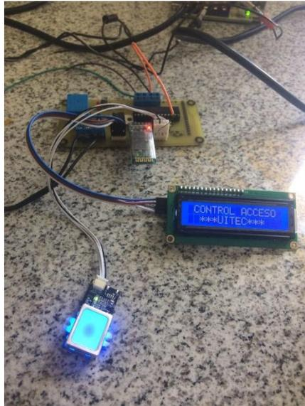
*Figura 46.* Placa Final del control de acceso para UITEC
