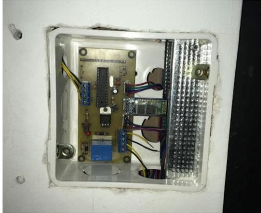
*Figura 53.* Parte trasera del sistema (Circuito Visible)
