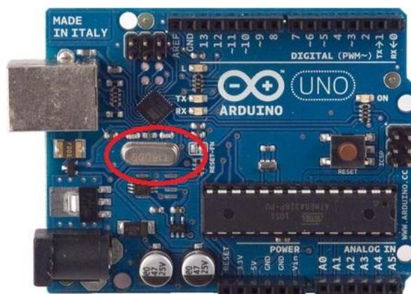
Figura 47. Cristal de Arduino UNO
