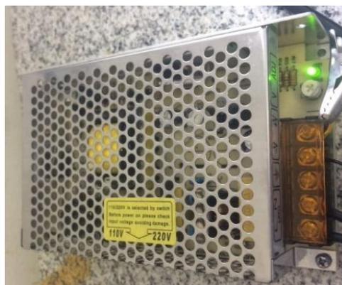
*Figura 42.* Transformador de voltaje 110 (v) a 12 (v)
