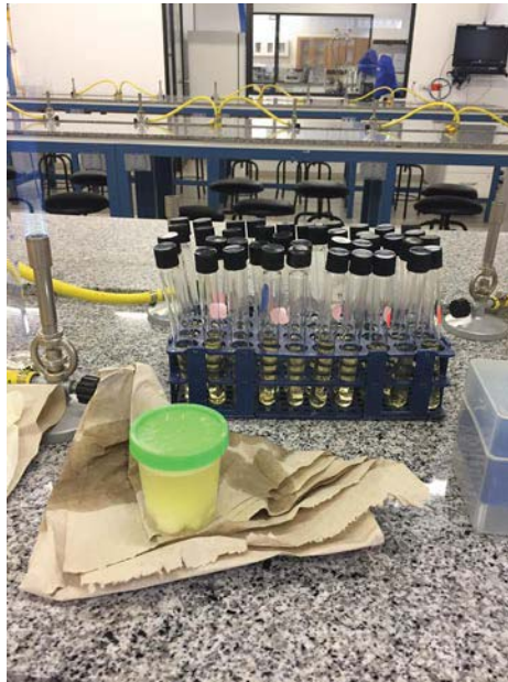
Figura 13. Agua de peptona en tubos de ensayo y frasco estéril con muestra de queso y agua peptona.
