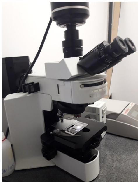
Figura 11. Microscopio preparado con cámara de McMaster con la muestra para medición de huevos y software
