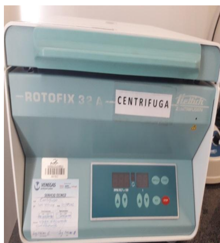
Figura 10. Centrifuga para la mezcla a 1500 rpm
