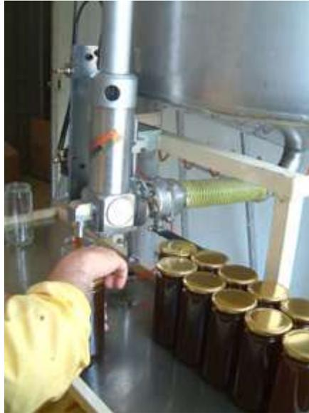
*Figura 46.* Conjunto envasadora con mesa rotativa, madurador
