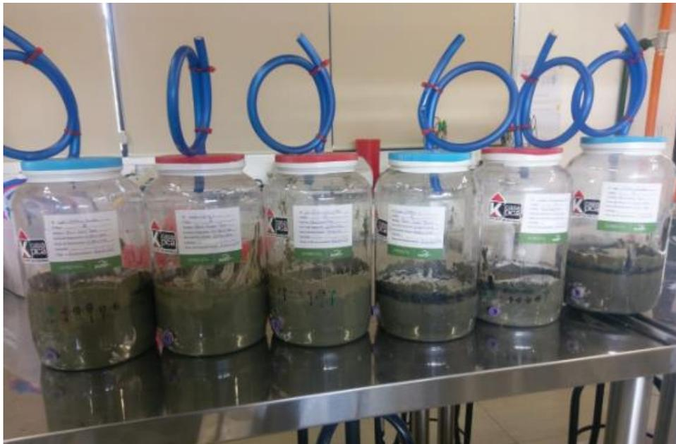
Figura 7. Unidad experimental de los Biodigestores
