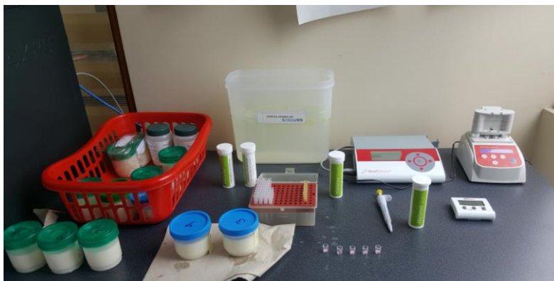
Figura 13. Materiales del Kit para la determinación de la muestra de leche cruda.
