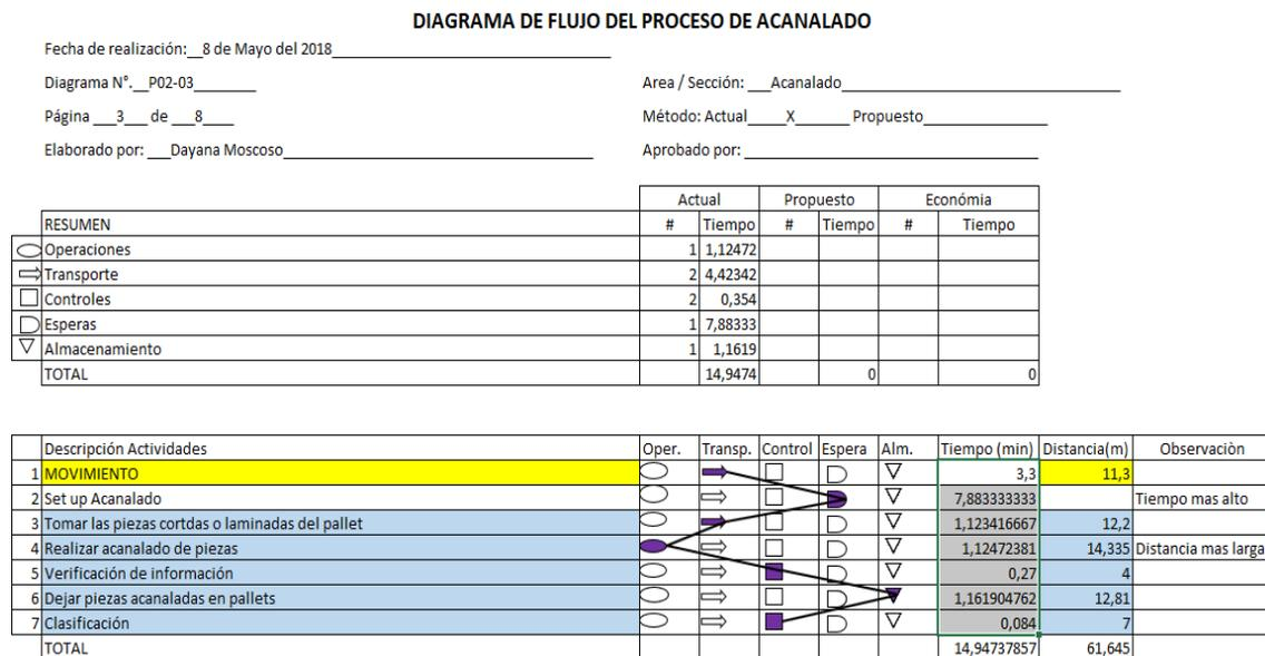
Figura 37. Diagrama de flujo del proceso de acanalado de piezas.
