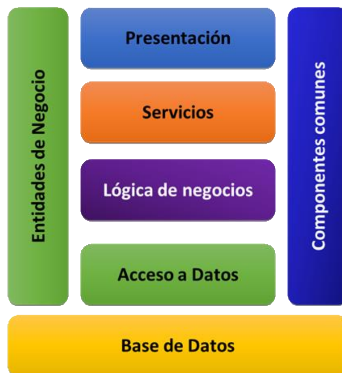
Figura 9. Arquitectura n capas
