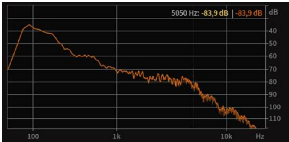
Figura 65. Espectro frecuencial del tom de piso en estudio profesional que muestra el nivel en la frecuencia de 5050 Hz.
