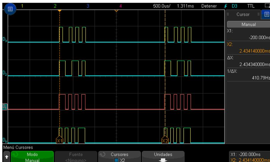
Figura 96. Período del byte  $\Delta X$  del canal D3 (incluido el retardo).
