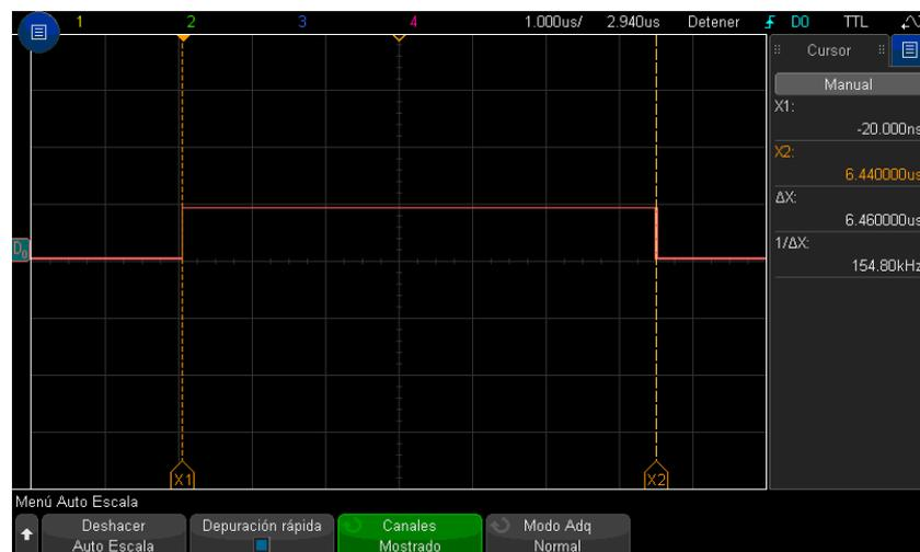
Figura 69. Medición de periodo y frecuencia de una señal digital.
