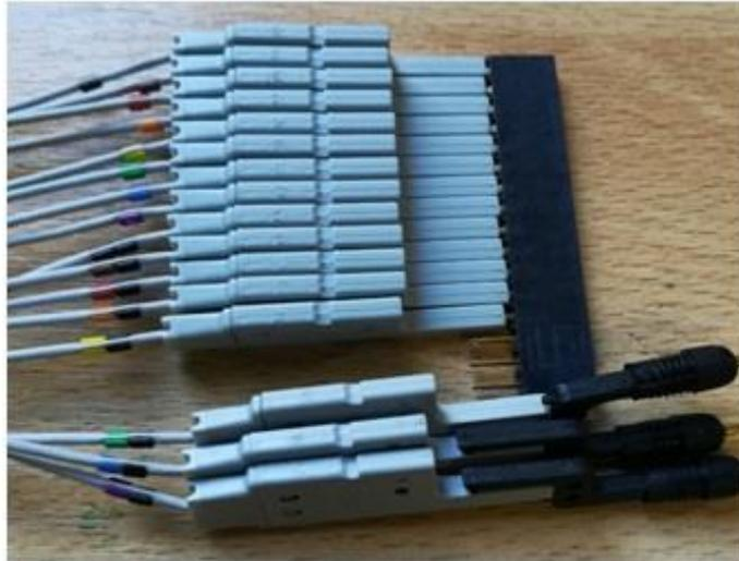
*Figura 36.* Estructura física de la sonda digital N2756A (Conector tipo vaina).
