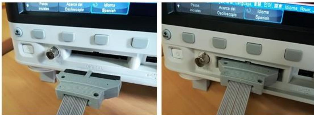
*Figura 99.* Forma correcta de conectar el cable de sonda digital en el Osciloscopio de señal mixta Keysight MSOX3014T.
