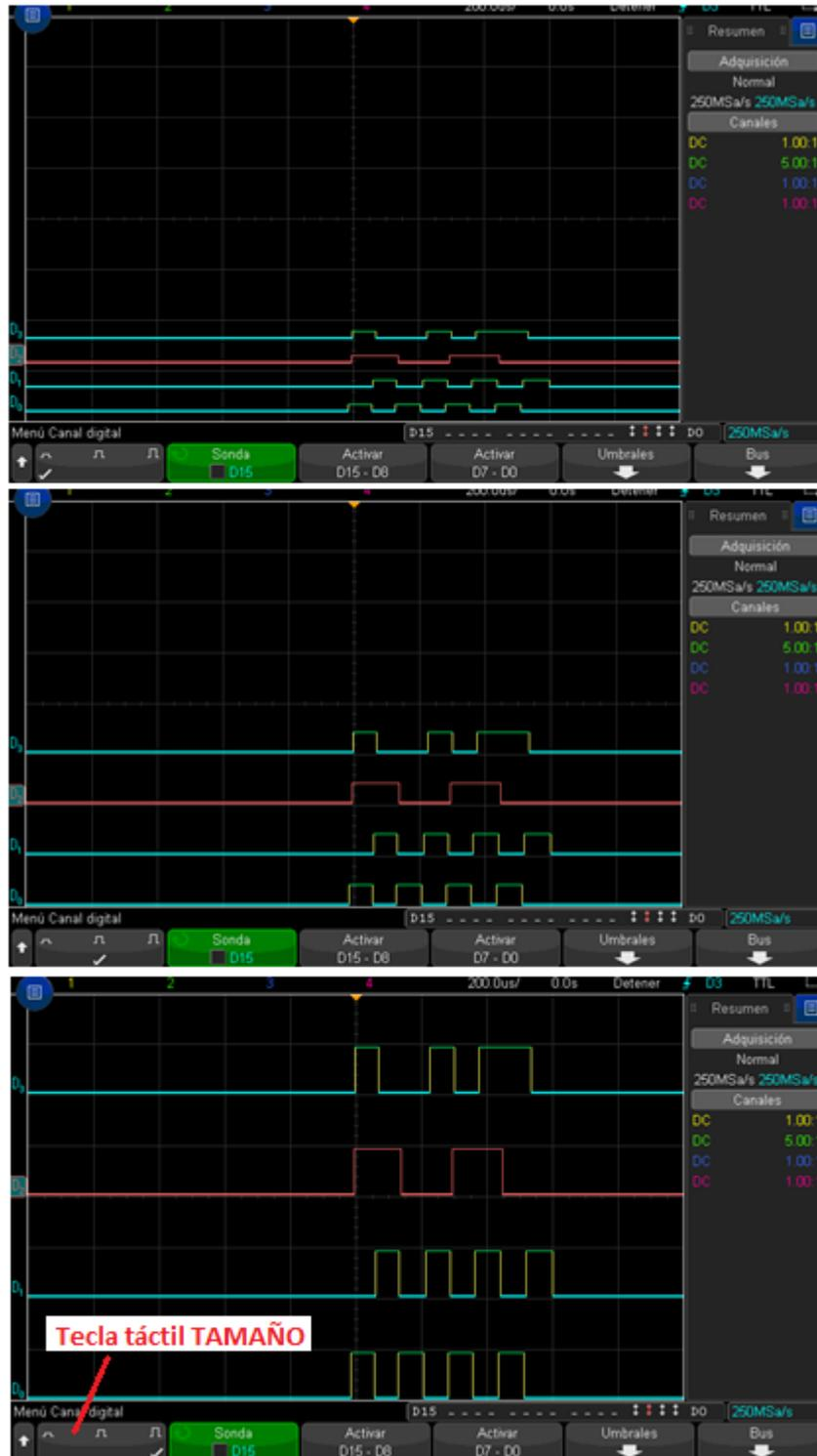
Figura 58. Señales digitales a distinto tamaño vertical con ayuda de la función tecla táctil Tamaño.
