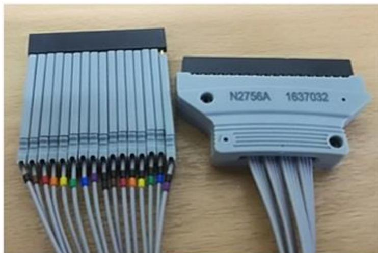
*Figura 42.* Vainas y conector principal de la sonda de señal digital N2756A.
