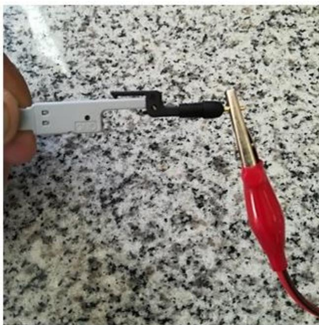
Figura 27. Conexión: punta de prueba – conector tipo vaina.
