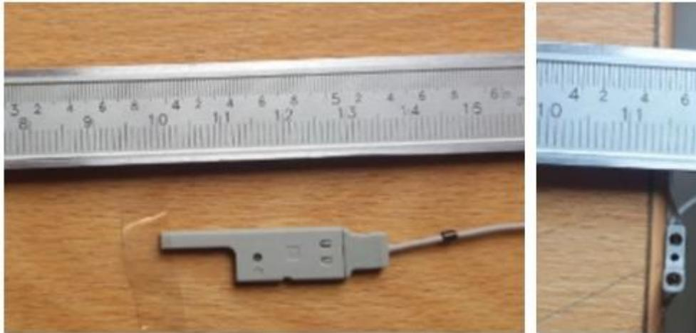
*Figura 44.* Conector tipo vaina de la sonda digital N2756A.
