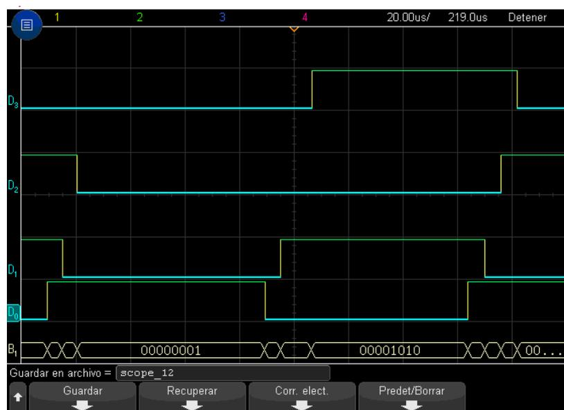
Figura 67. Visualización completa del BUS en binario.
