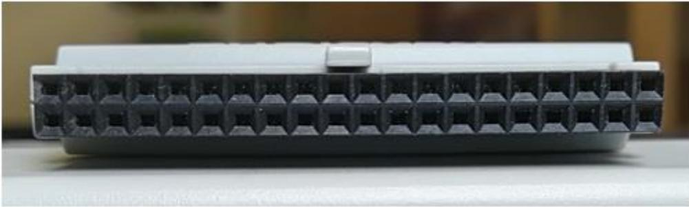
*Figura 33.* Puntos de conexión del conector de la sonda N2756A.
