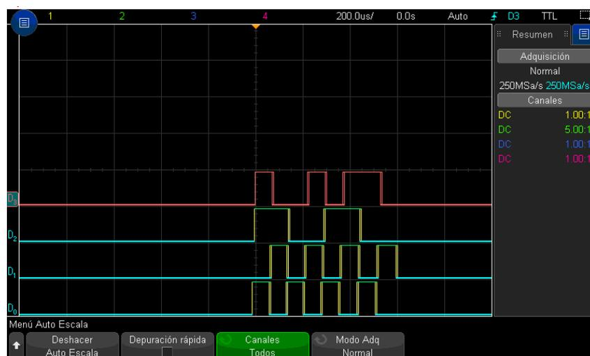
Figura 55. Señales digitales mostradas con la configuración Auto Scale.
