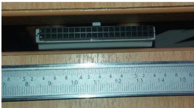
*Figura 43.* Conector principal de la sonda digital N2756A.
