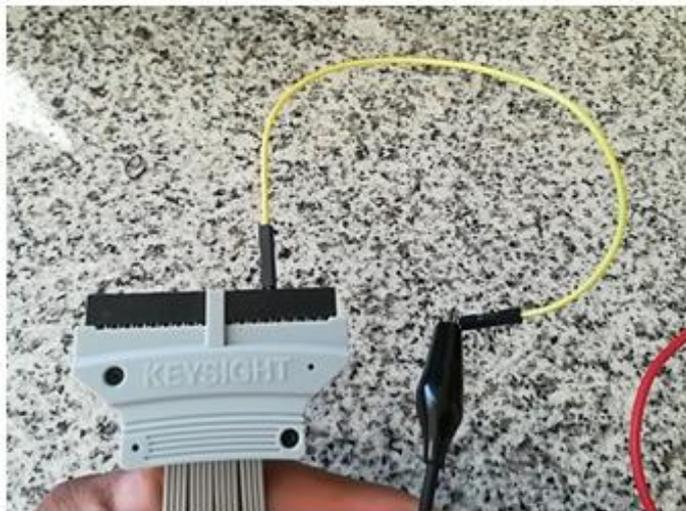
*Figura 28.* Conexión: Punta de prueba – Conector principal de sonda.
