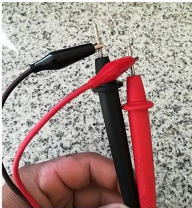
*Figura 29.* Conexión: puntas de prueba – Puntas multímetro.
