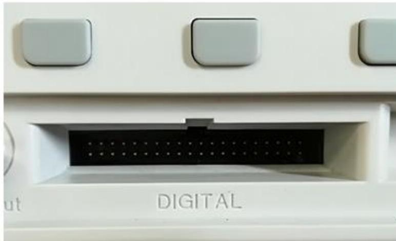
*Figura 18.* Puerto de entradas digitales del MSO Keysight MSOX3014T.
