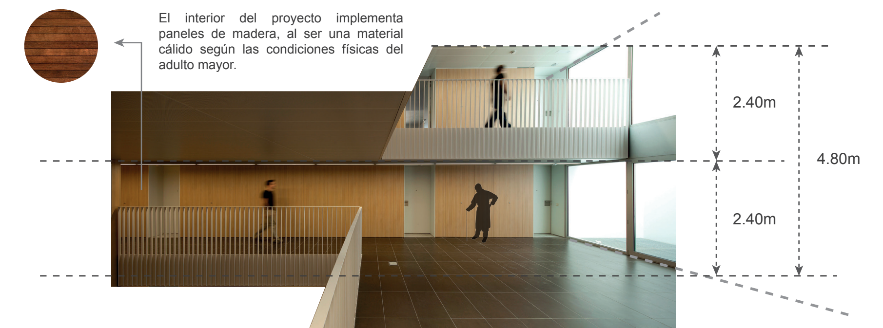
Figura 110. CAP Cibeles, Escala proyecto / usuario-materialidad. Adaptado de (Plataforma Arquitectura, 2017)
