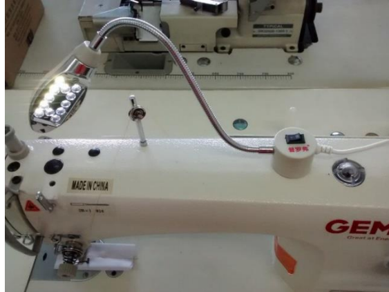
Figura 69. Propuesta de Implementación de luz LED en máquinas de coser Adaptado de (Maqitex, s.f.)
