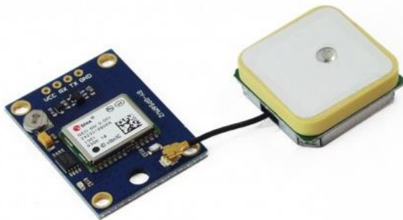
Figura 20: Sensor GPS Neo UBLOX Tomado de naylampmechatronics(2017)
