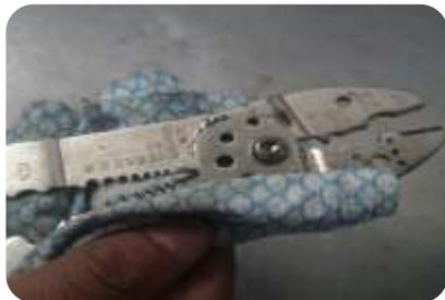
Figura 61. Secado de Herramientas
