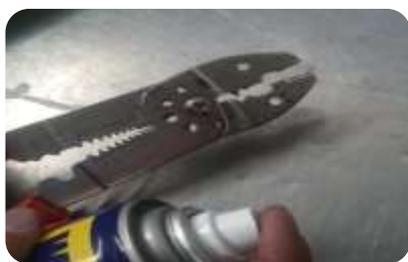
Figura 62. Lubricación de Herramientas
