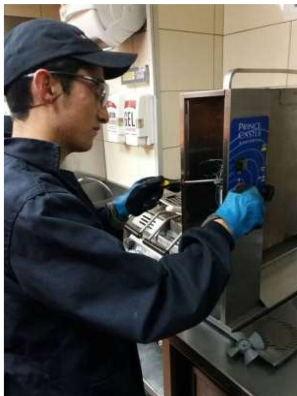
Figura 3. Cambio de Aspas de Ventilación del Equipo
