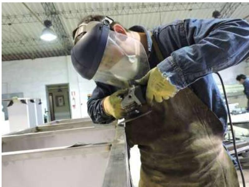
Figura 13. Proceso de Lijado de Esquinas de Equipos
