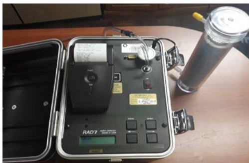
Figura 12. Detector electrónico profesional de radón RAD7.
