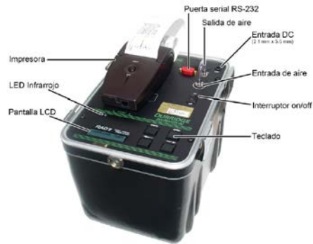
Figura 6. Detector de radón electrónico RAD7.
