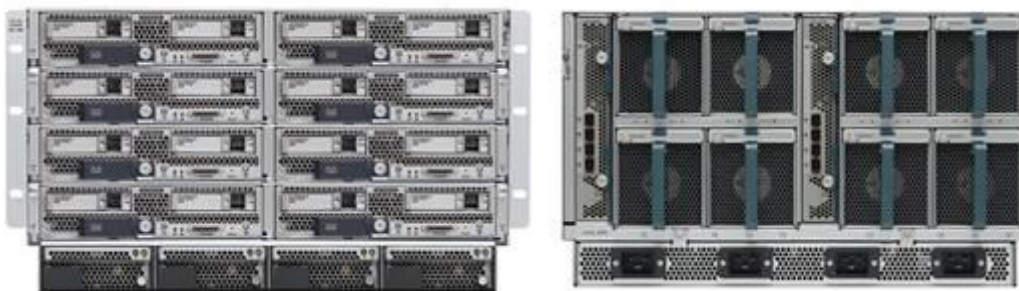
Figura 21. Cisco UCS 5108 con servidores Blades delante y detrás
