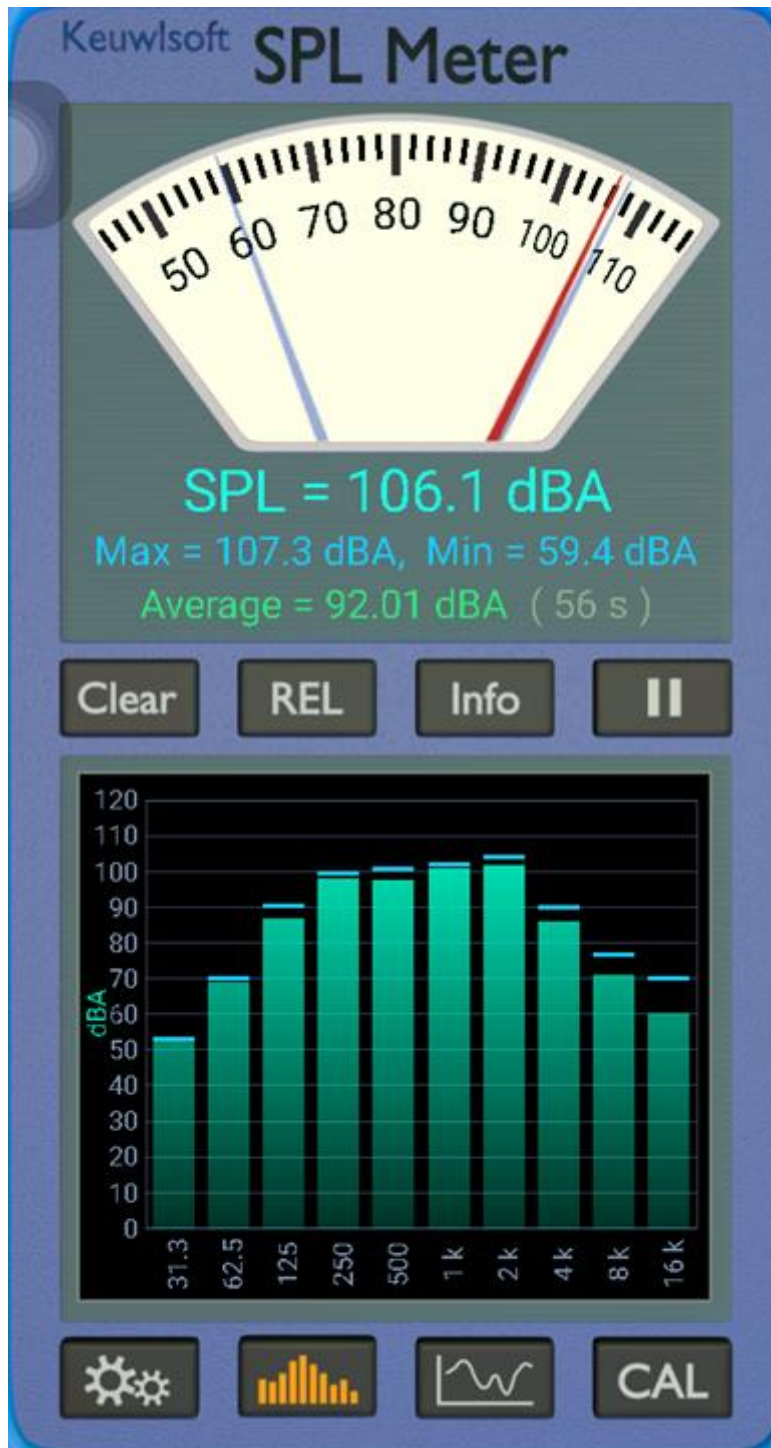
Figura 74 Medición emitida por fuente fija ubicación 1m. fuera de área 2 sin aislamiento.
