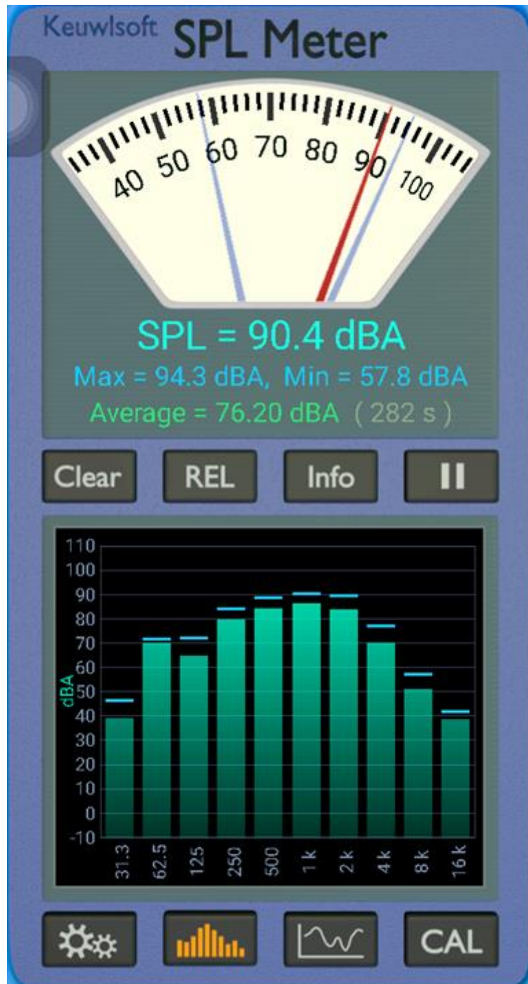
Figura 77 Medición dentro de área 1 con aislamiento y ruido emitido por fuente fija a 1m. en ubicación frontal
