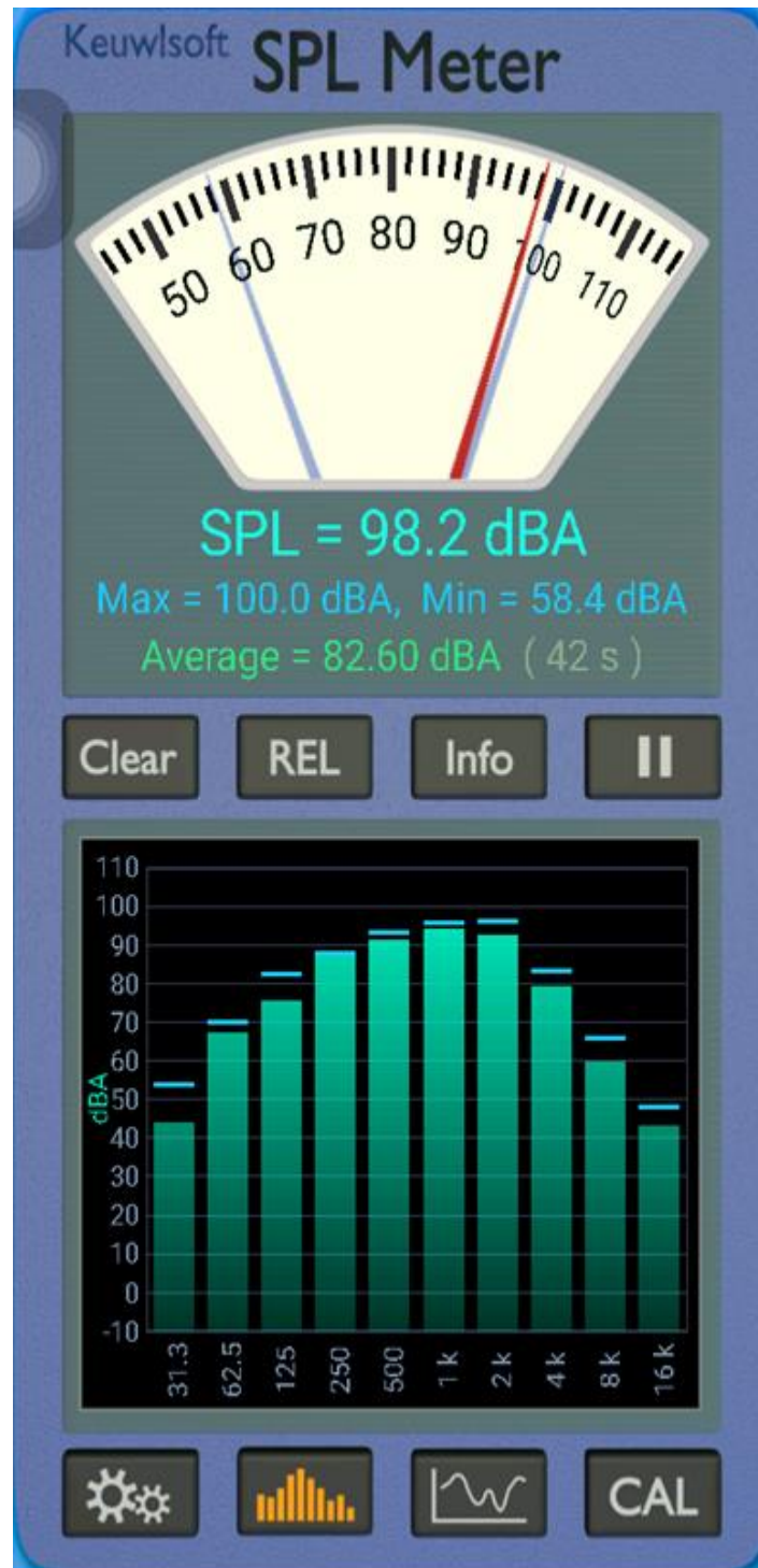
Figura 78 Medición dentro de área 2 sin aislamiento y ruido emitido por fuente fija a 1m. de distancia en ubicación lateral 1
