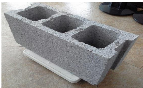
Figura 19 Bloque hueco de hormigón: 20 altura x 40 longitud x 15 de ancho.
