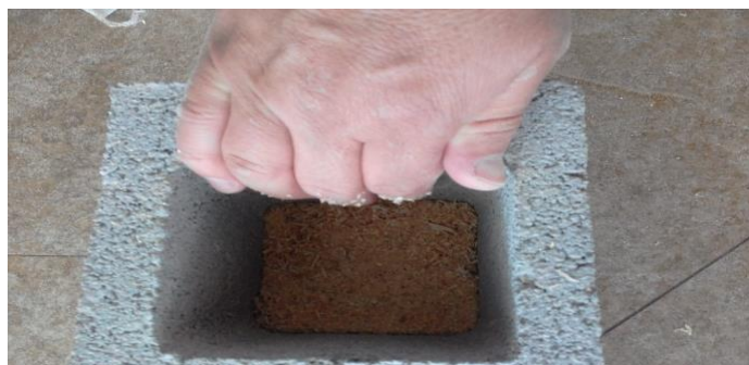
Figura 22 Introducción inicial del aserrín pulverizado en el bloque.
