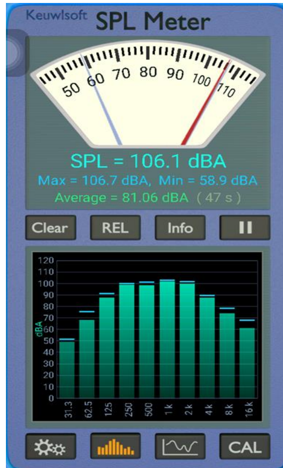
Figura 73 Medición emitida por fuente fija ubicación 1m. fuera de área 1 con aislamiento.
