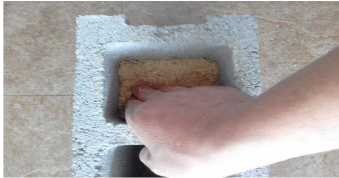
Figura 23 Introducción media de aserrín pulverizado en orificio de bloque.
