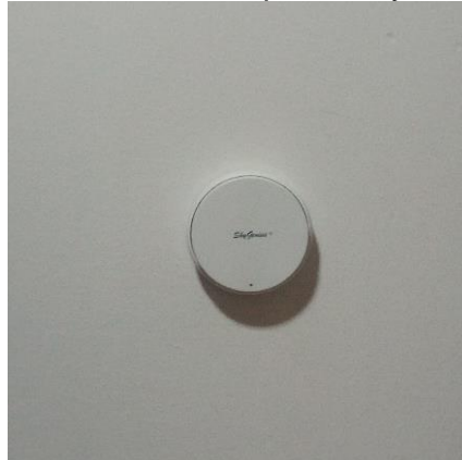
Figura 72. Interruptor transmisor SKG-Wr01 instalado en la pared
