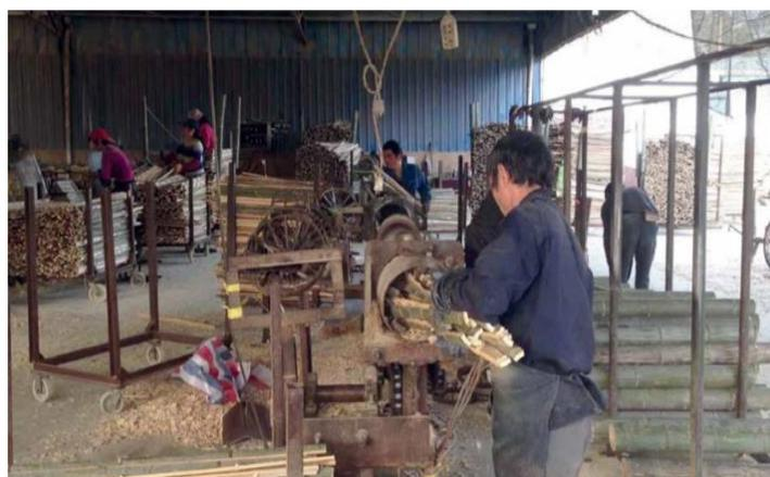
Figura 52 Foto de método de curado por bouchiere. Tomado de: Tesis de grado 1990 U. Central.
