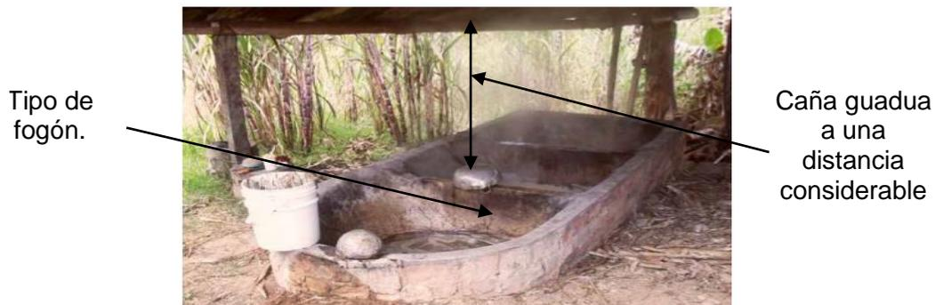
Figura 51 Foto de método de curado por exposición al humo. Tomado de: Tesis de grado 1990 U. Central.
