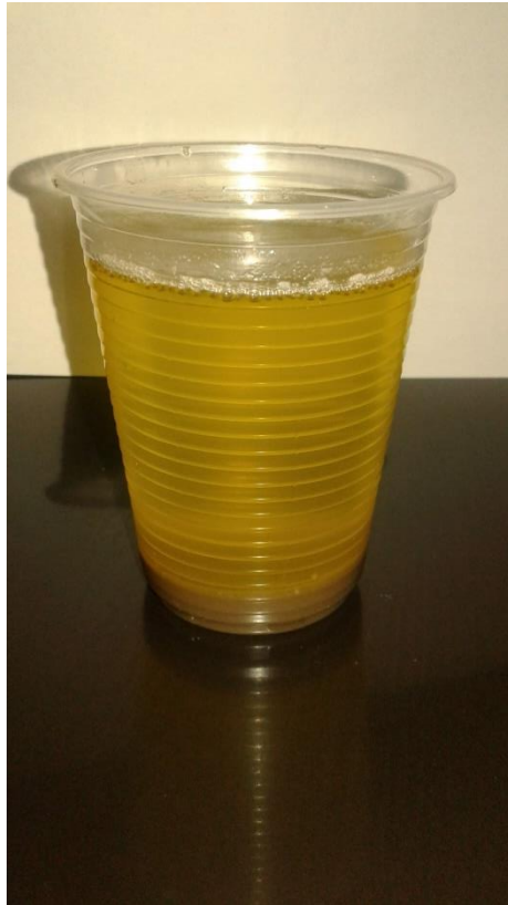
Figura 24. Sedimentación de aceite de girasol con torta húmeda.
