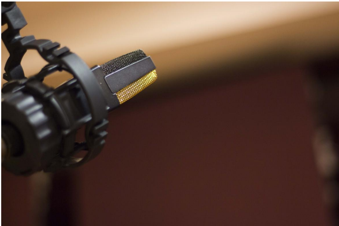
Figura 12: AKG C414 cumpliendo la función de overhead en la batería
