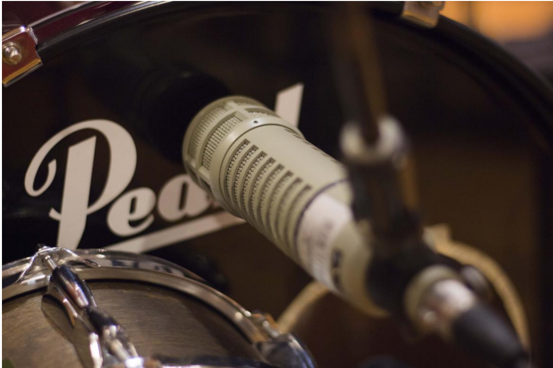
Figura 11: Electro-Voice RE20 cumpliendo la función de Arm Kick en el bombo
