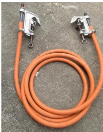
Figura 16. Cable de puente aislado de 15 kV
