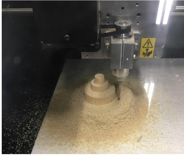
Ilustración 39 Maquinado Fresadora CNC – Avance en tareas de maquinado
