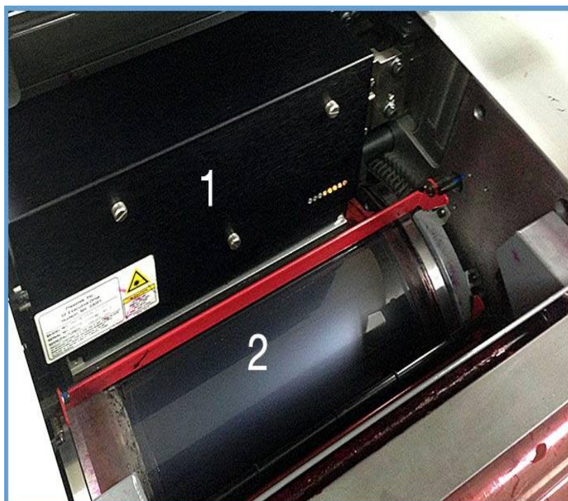
Figura 28. Láser y plancha de una impresora, 1.-Cabezales 2.-Plancha de impresión virgen.
