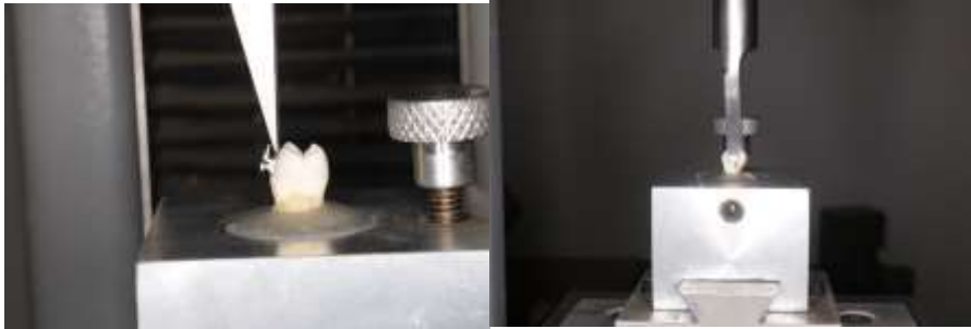
Figura 14. Acoplamiento del conjunto diente y bracket cementado en máquina de ensayos mecánicos, cuchilla posicionada en unión esmalte bracket previo a ser sometida a la fuerza.
