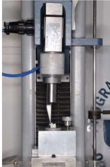
Figura 13. Máquina de ensayos mecánicos Instron Universal empleada nótese la colocación de la cuchilla en la unión esmalte bracket.
