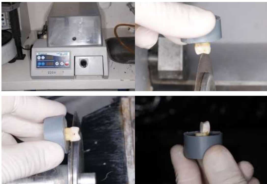
Figura 15. Separación del fragmento dental mediante máquina recortadora para observación al MEB.
