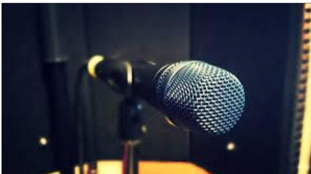
*Figura 22: Micrófono Sennheizer e935, vocal, dinámico, cardiode.*
