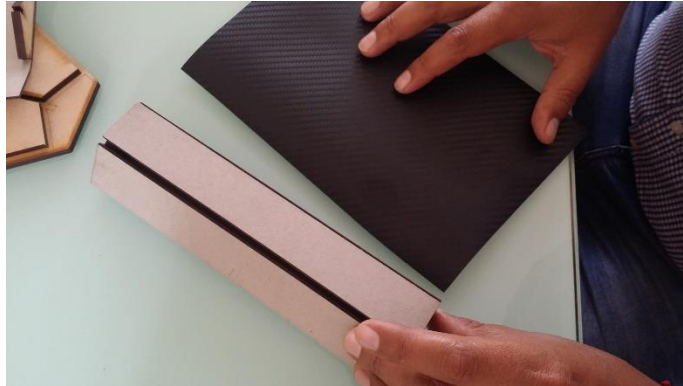
Figura 132. Corte en cartón gris de los laterales de las tapas y vinil de fibra de carbono texturado para recubrir.
