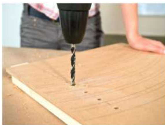
Figura 106. Perforación con taladro y broca.
