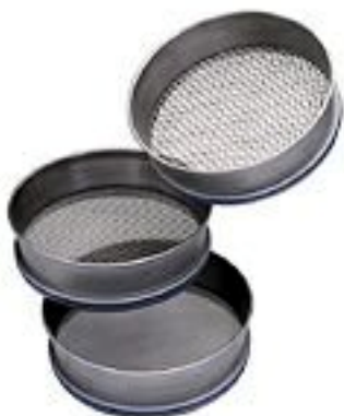
Figura 20. Mallas estándar de 1", \frac{3}{4} ", \frac{1}{2} ", \frac{3}{8} ", No.4 y No.12
