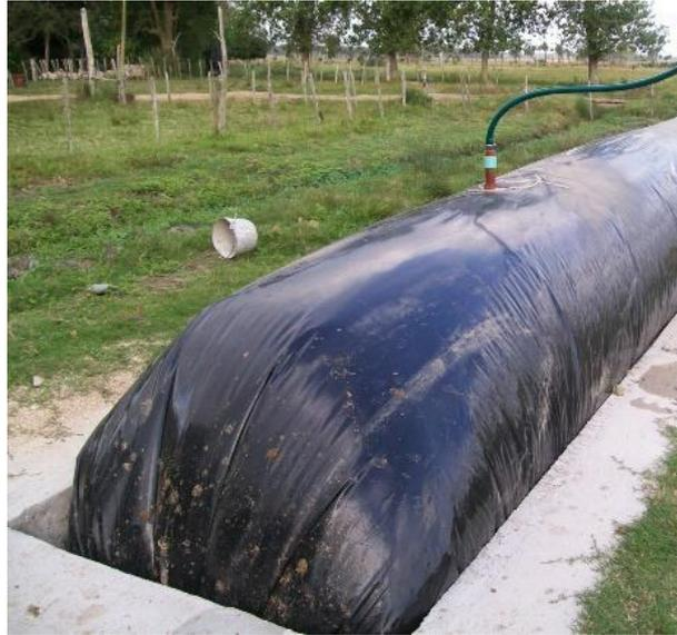
Figura 17. Biodigestor tipo salchicha
