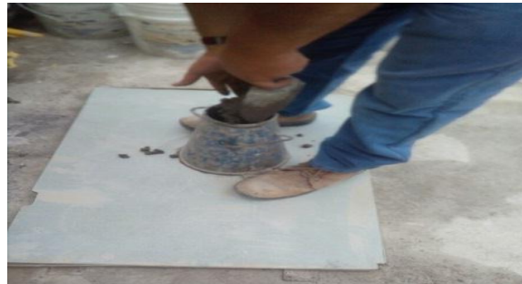
FIGURA 35. Colocación de hormigón en cono.
