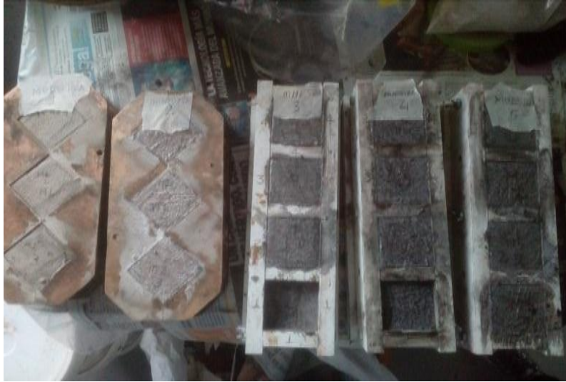
FIGURA 30. Especímenes en moldes de encofrado.
