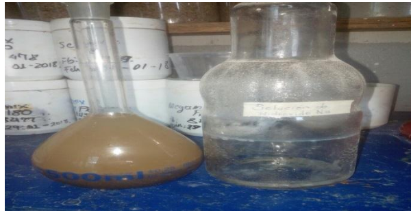
FIGURA 16. Ensayo de contenido orgánico en agregado fino.
