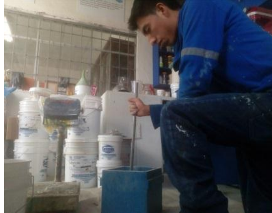
FIGURA 24. Proceso de apisonado de agregado.
