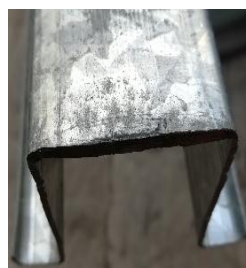
Figura 19. Forma del Perfil Omega y sus dimensiones
