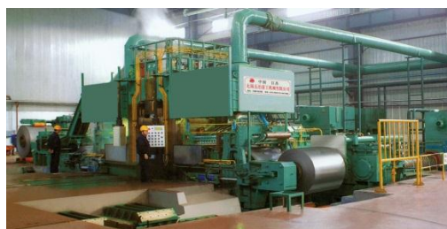
Figura 17. Máquina para embobinar el Acero galvanizado frío
