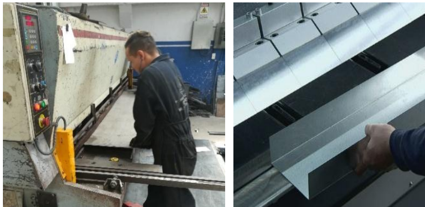
Figura 22. Máquina de corte y doblado del Acero galvanizado
