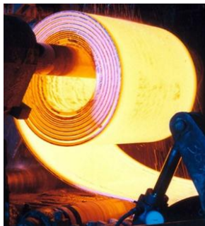
Figura 16. Acero galvanizado al embobinarse en caliente
