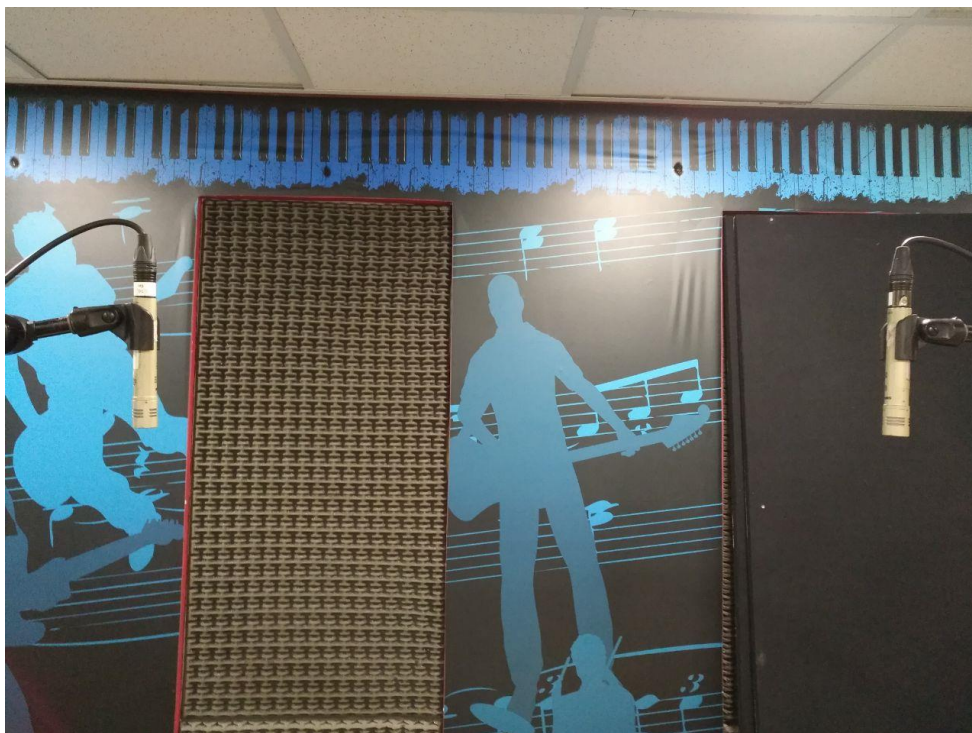
Figura 10. Microfonia para Oveheads A-B con Shure KSM-137
