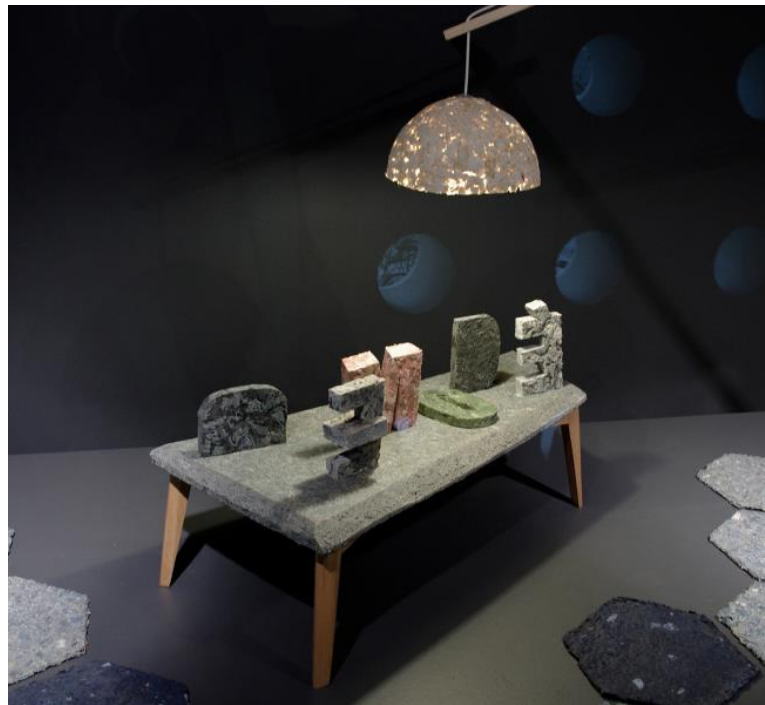
Figura 16. Mesa, lámpara y accesorios de escritorio elaborados con residuo textil y prensado con adhesivo.
