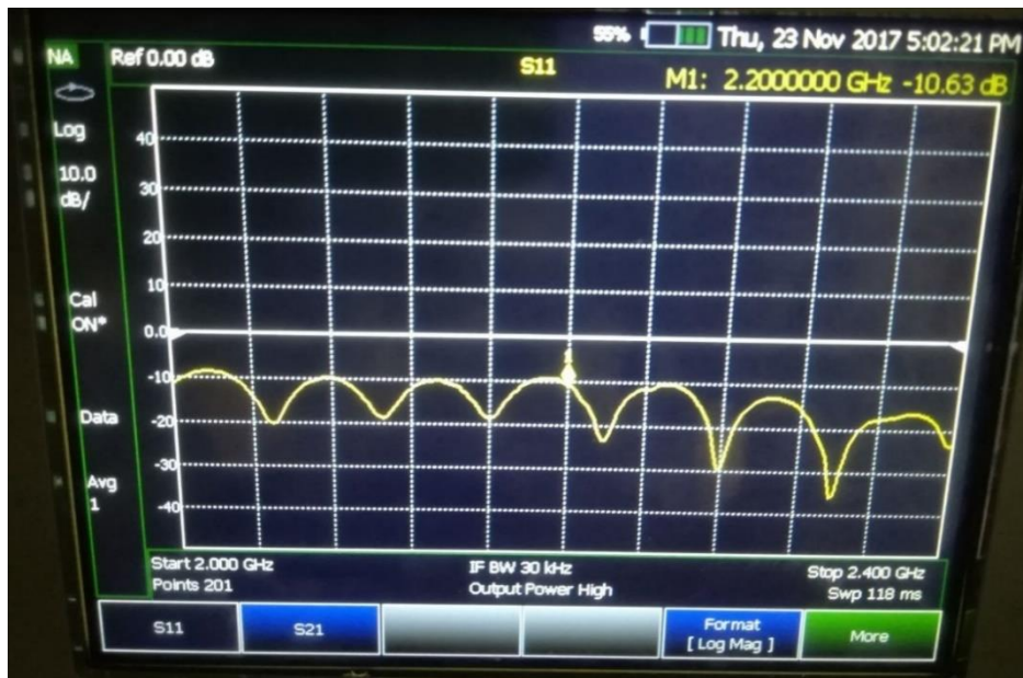
Figura 93: Señal de la antena receptora en formato “Log Mag” en el analizador N9912A.
