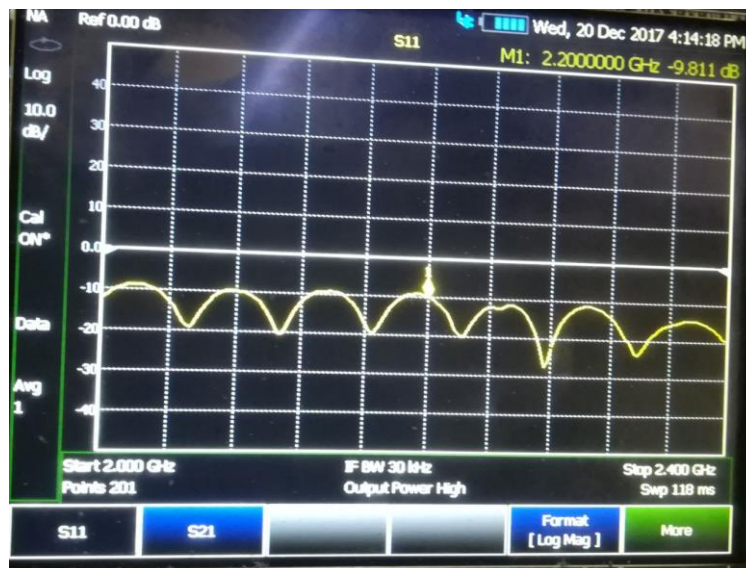
Figura 161: Señal con el material absorbente de la antena receptora en formato "Log Mag" en el analizador N9912A.
