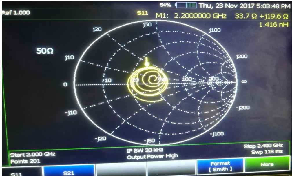
Figura 96: Señal de la antena receptora en formato “Smith” en el analizador N9912A.
