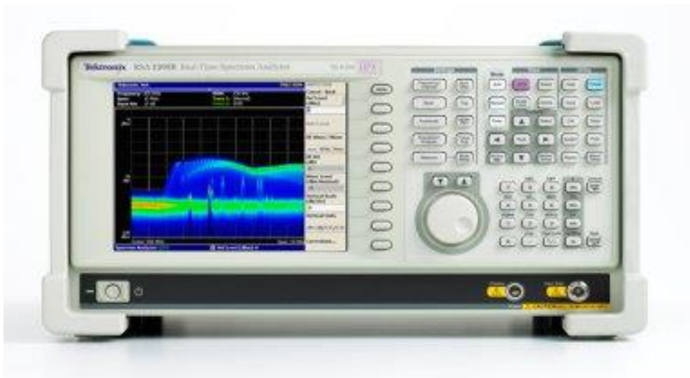
Figura 13: Analizador de espectros analógico. Tomado de Ingeniería Electrónica, 2016.
