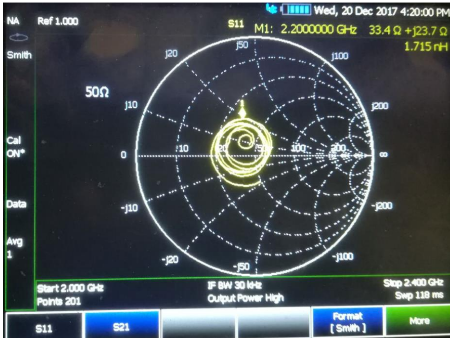
Figura 158: Señal con el material absorbente de la antena receptora en formato “Smith” en el analizador N9912A.
