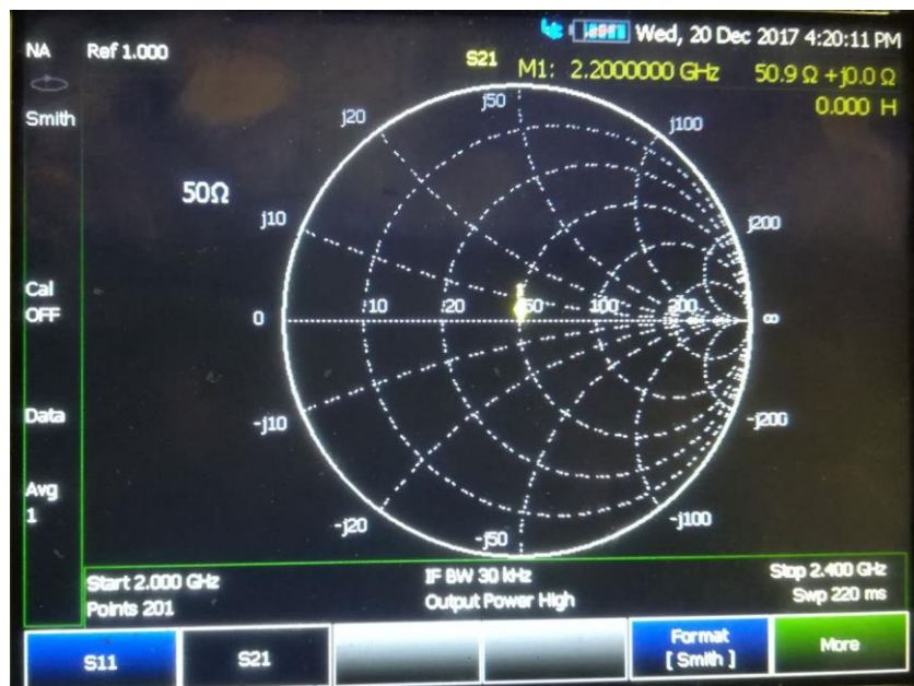
Figura 159: Señal con el material absorbente de la antena emisora en formato “Smith” en el analizador N9912A.
