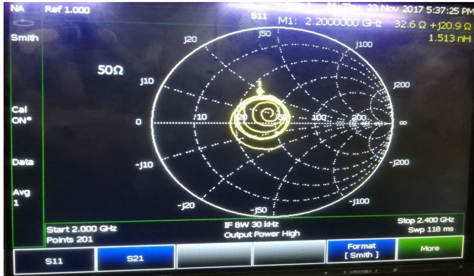
Figura 102: Señal de la antena receptora en formato “Smith” en el analizador N9912A.
