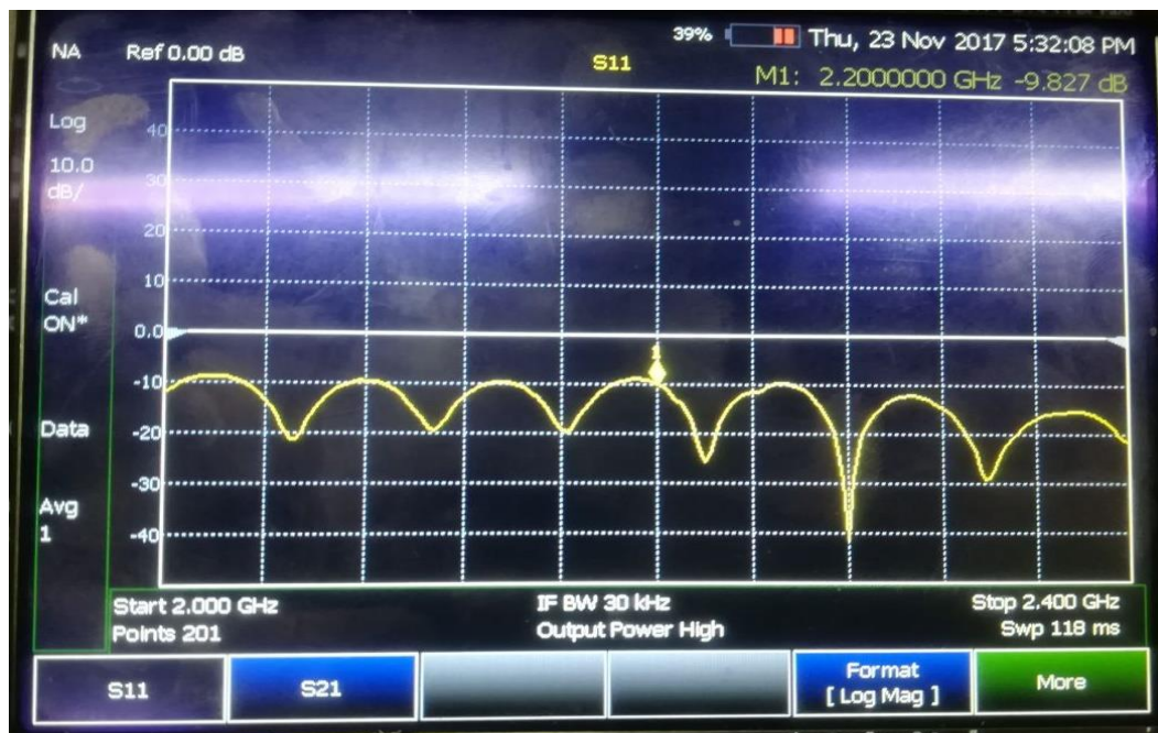
Figura 99: Señal de la antena receptora en formato “Log Mag” en el analizador N9912A.
