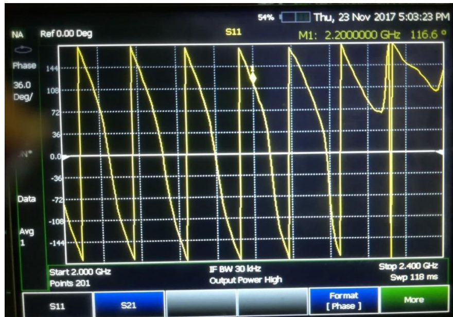
Figura 95: Señal de la antena receptora en formato “Phase” en el analizador N9912A.
