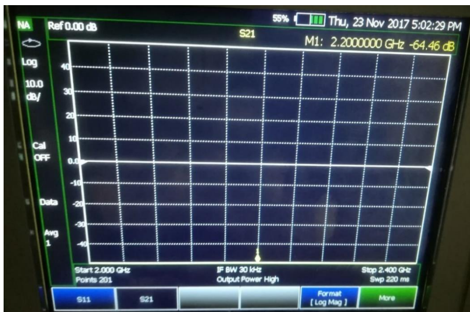
Figura 94: Señal de la antena emisora en formato “Log Mag” en el analizador N9912A.
