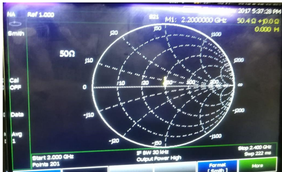
Figura 103: Señal de la antena emisora en formato “Smith” en el analizador N9912A.
