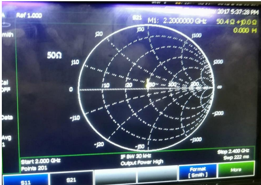
Figura 109: Señal de la antena emisora en formato “Smith” en el analizador N9912A.
