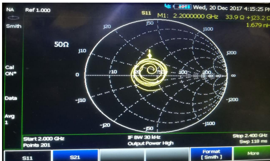
Figura 164: Señal con el material absorbente de la antena receptora en formato “Smith” en el analizador N9912A.
