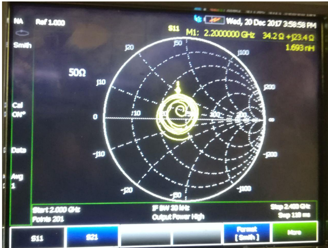
Figura 171: Señal con el material absorbente de la antena receptora en formato "Smith" en el analizador N9912A.
