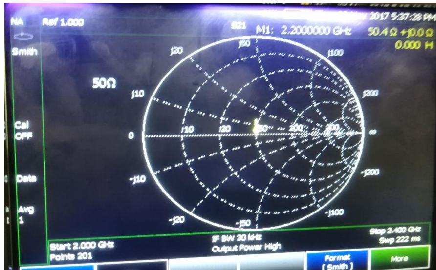
Figura 165: Señal con el material absorbente de la antena emisora en formato "Smith" en el analizador N9912A.
