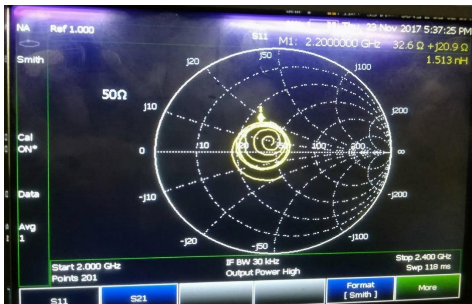
Figura 108: Señal de la antena receptora en formato “Smith” en el analizador N9912A.
