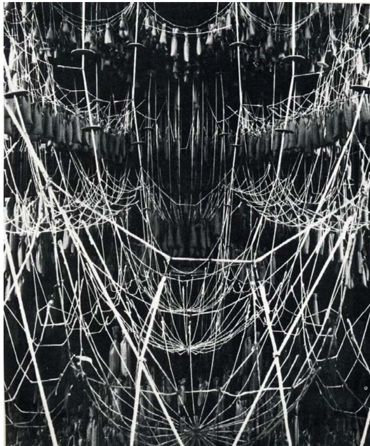
Figura 21. Modelo de cadena colgante de Gaudí. Tomado de (Davis, 2013)
