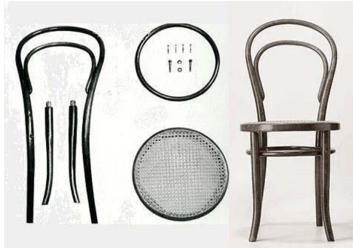
Figura 3. Silla N°14 también conocida como silla Thonet fabricada con tecnología de doblado al vapor, producto de la revolución industrial
