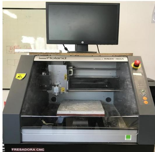
*Figura 15.* Fresadora CNC 3 ejes.
