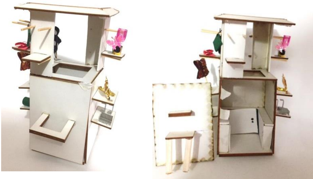
Figura 29. Prototipo puesto de venta adaptacion de lineas de productos, agarradera para movilizar el puesto de venta, almacenamiento en si mismo, sitio de descanso para el usuario.
