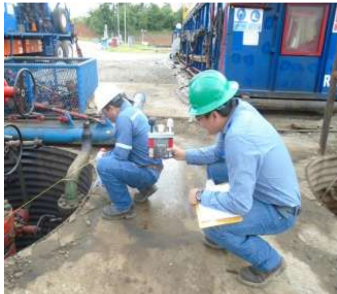
Figura 39. Medición del estrés térmico al puesto de jefe de pozo.
