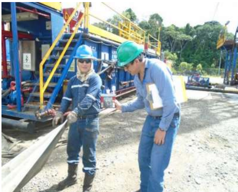
Figura 53. Medición del Estrés térmico al puesto del obrero de patio uno, r Tomado de: Triboilgas, 2017.
