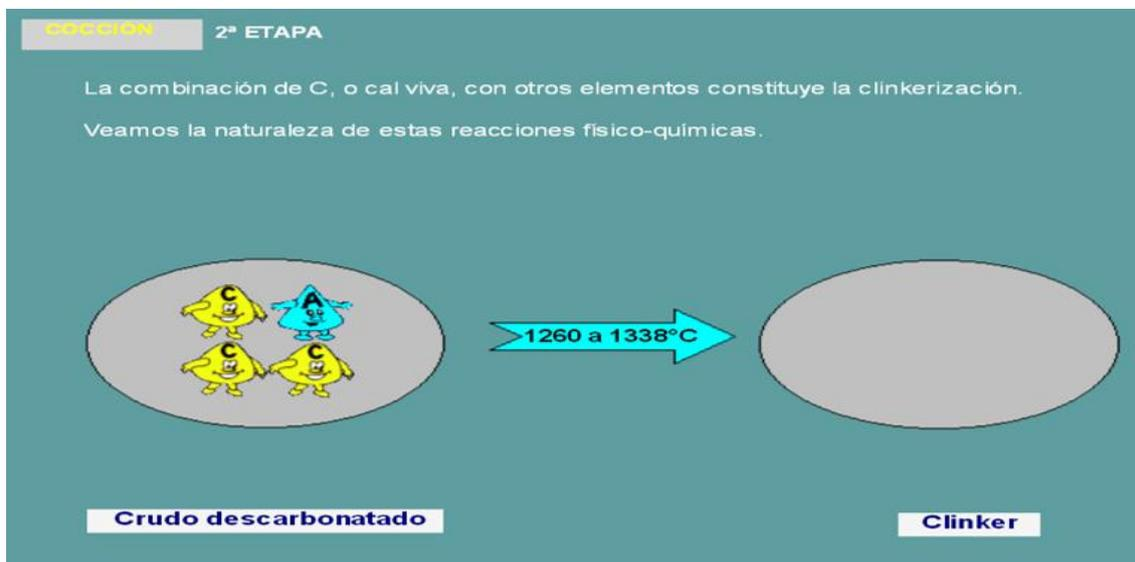
Figura 6 Proceso de elaboración de cemento
