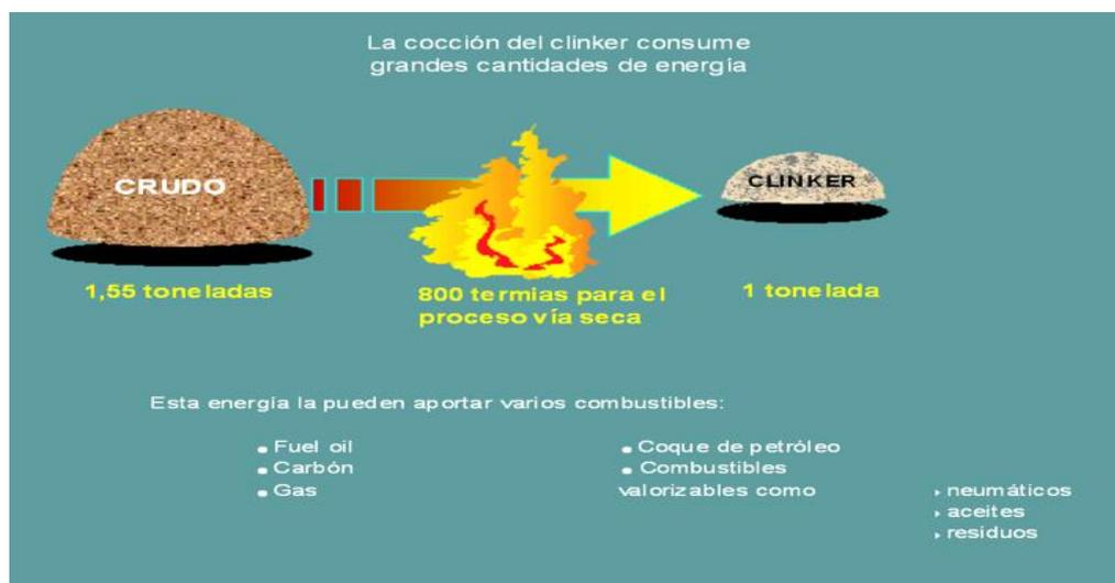
Figura 15 Proceso de elaboración de cemento
