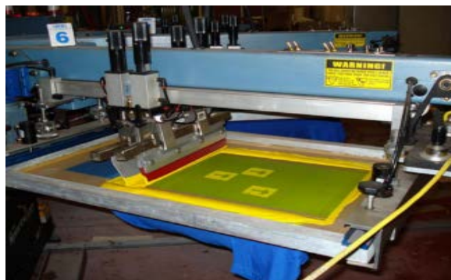
Figura 35. Ejemplo de impresión de serigrafía en la industria textil Tomado de (Serigrafía, s.f.)
