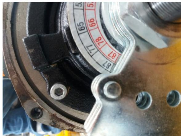
*Figura 34.* Ajuste de frecuencia de vibración.
