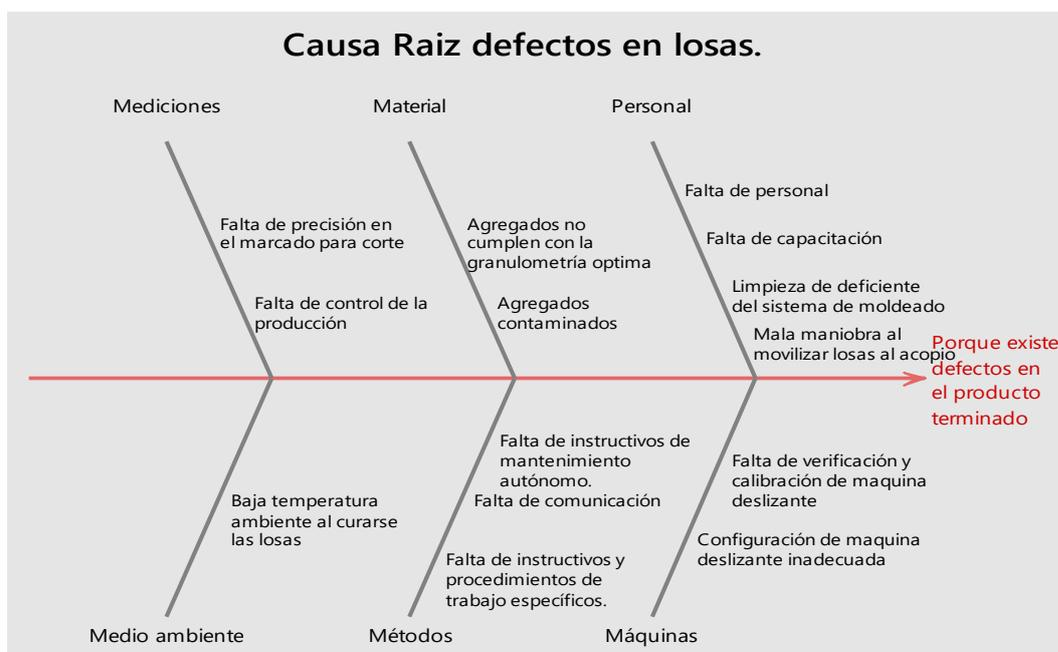
Figura 30. Causa Raíz defectos en losas (minitab)
