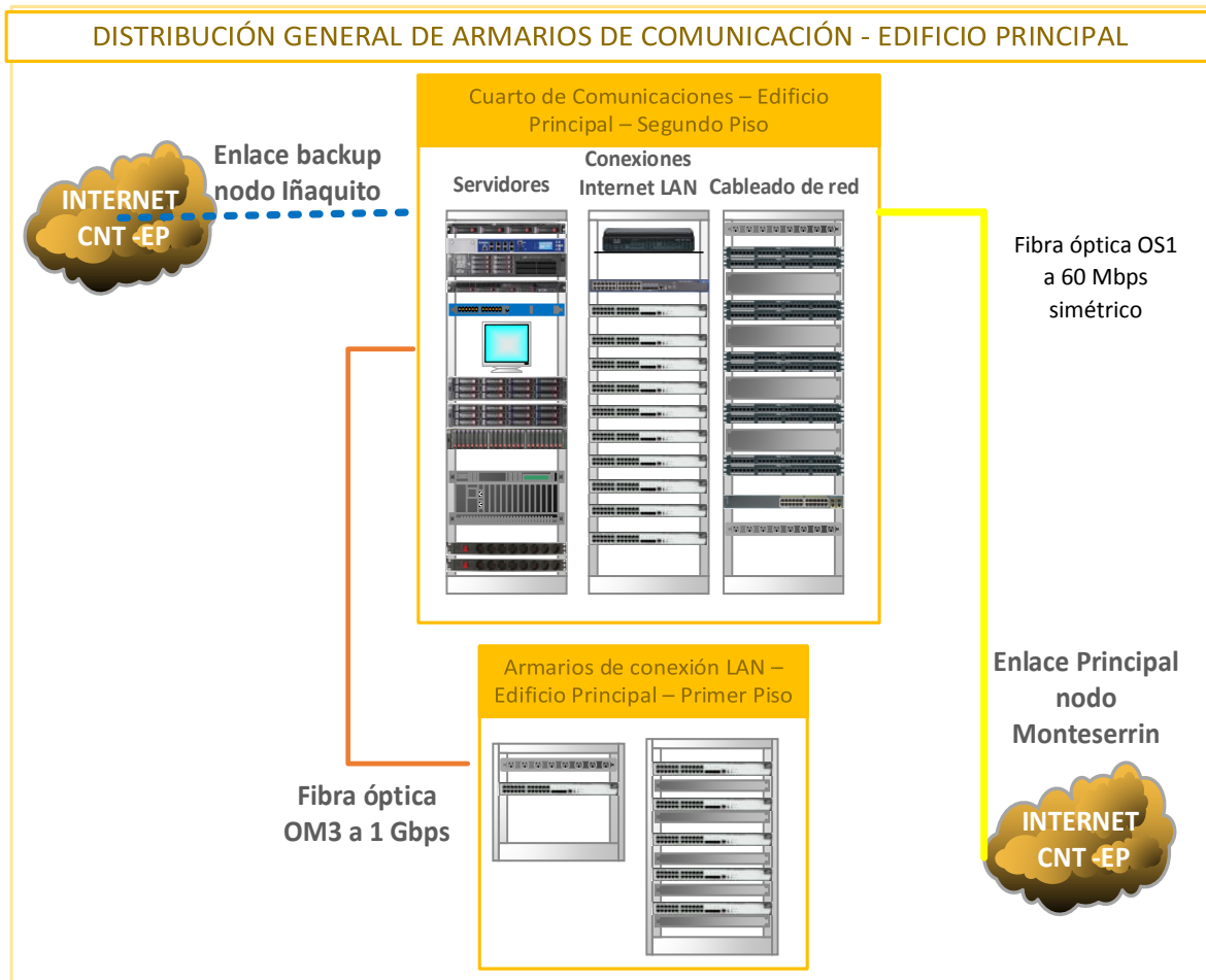
Figura 36: Distribución General de armarios de comunicación - Edificio Principal.
