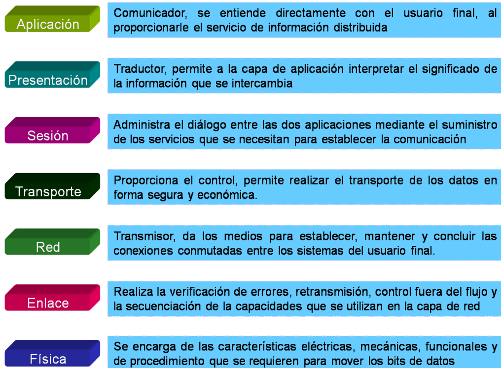
Figura 2: Modelo OSI /ISO de capas para las comunicaciones de red, Tomado de (Jaimes, 2015)
