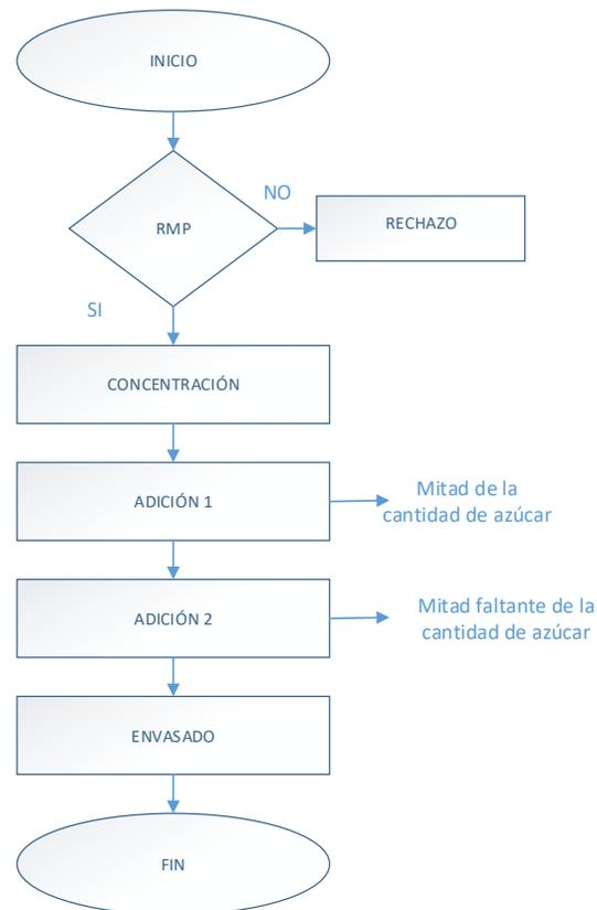
Figura 7. Diagrama de flujo proceso elaboración de leche condensada.
