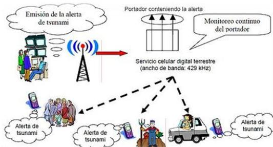
Figura 1. Sistema de Alerta de Tsunamis
