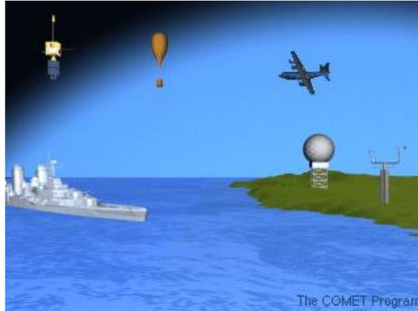
*Figura 61.* Componentes de un SAT de observación de Huracanes
