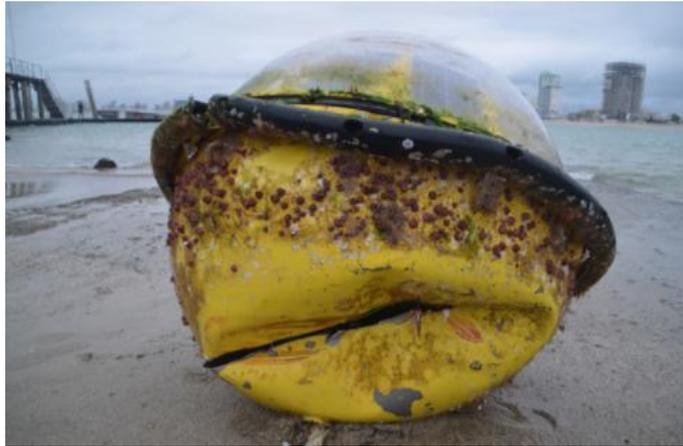
*Figura 84.* Boya meteorológica con daños considerables - Salinas – Ecuador
