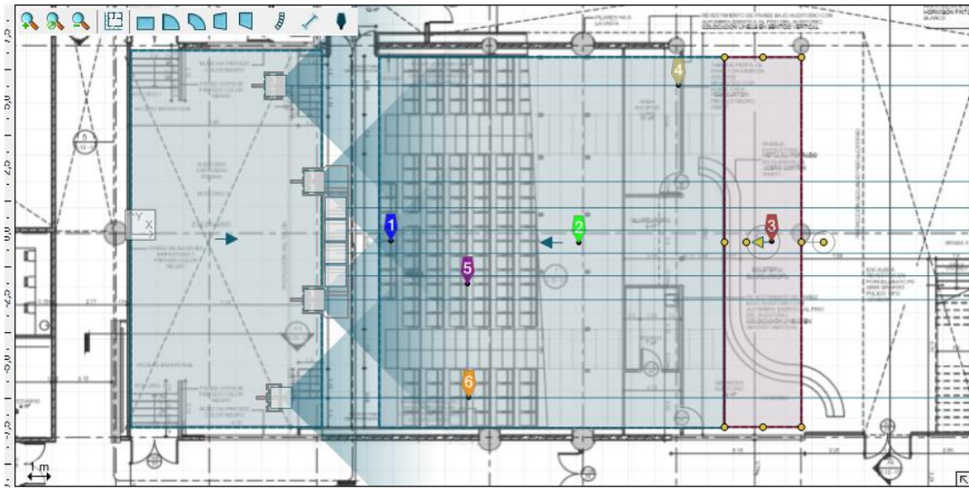
Figura 19. Vista aérea del auditorio con puntos de medición.
