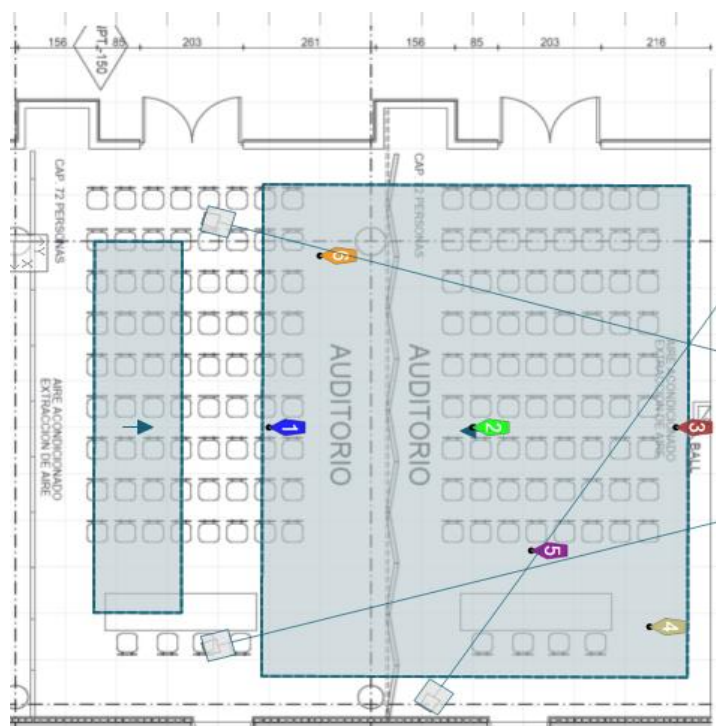
Figura 63. Posiciones de medición en el auditorio 2 de la sede Granados.
